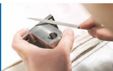
加工後の表面処理や熱処理などをおこない、精度を高めるとともに、長寿命化を図ります。機械では成し得ない表面のなめらかさや微細な凹凸の研削など、図面通りの仕上がりを追求し、やすりかけなど手作業で最終仕上げを施します。エンジニアとしての感性や美意識が働く工程でもあります。
