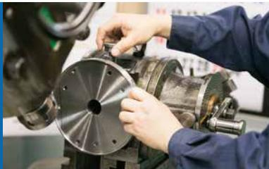
治具(じぐ)は、部品や工具の作業位置を正確に導くために重要な器具となります。当社では、時に現場の社員が独自の発想で製作することも多く、作業の精度向上、効率化に貢献しています。
